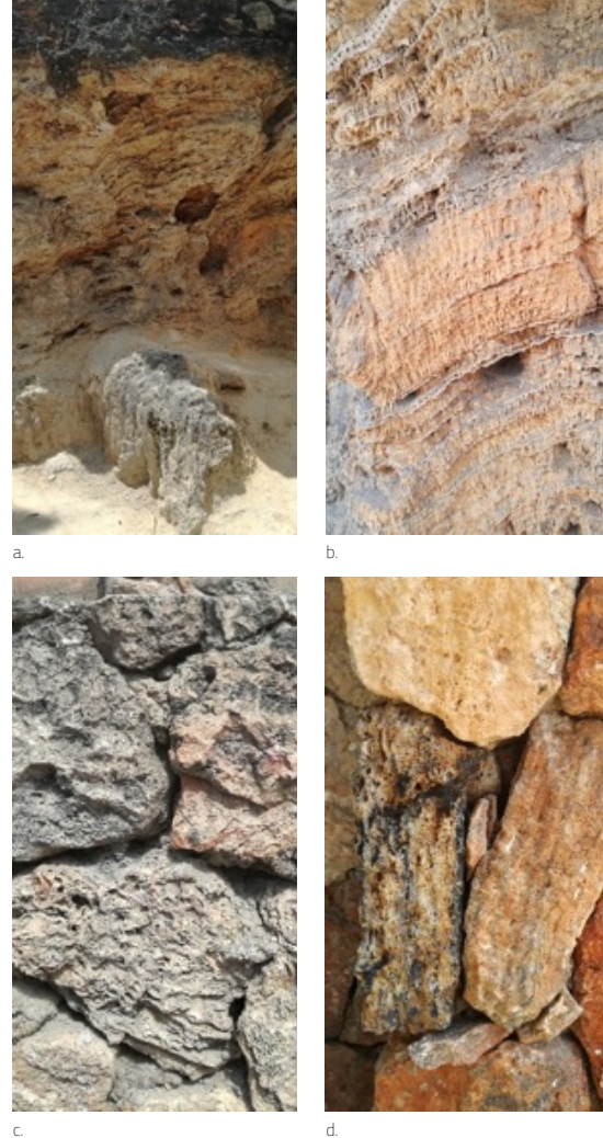
Figura N° 3 Formaciones calcáreas en Piedra de Agua-Cuenca-Ecuador: a y b entorno natural, c y d detalles de uso en construcción de tapiales. Fotografías realizadas por M. I. Sánchez en 2019.
