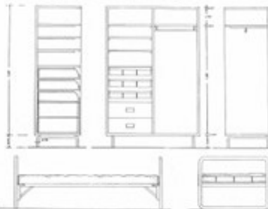
Cama de tubo de acero, perfil longitudinal y transversal (modelo "Erasmo").
