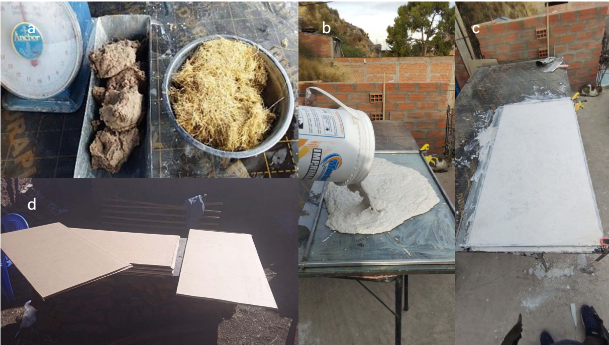
Figura 2: (a) Fibra de Stipa Ichu y celulosa, amasado y trillado. (b) Mezcla de las fibras con yeso. (c) Vaciado en molde metálico. (d) Acabado final del panel con papel. (2024)
