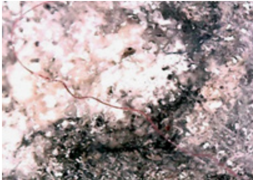
Figura 9: Sales y microrraíces observadas mediante microscopía USB Digital en fachada recién restaurada Fuente: S. Arencibia (2018)
