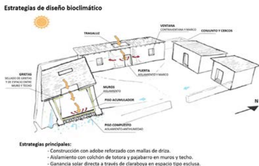
Figura 6: Esquema de la propuesta con las estrategias bioclimáticas pasivas
