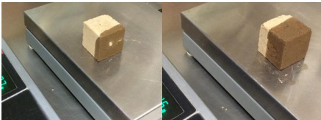
**Figura 5:** Registro del peso de las probetas cúbicas en periodos controlados, según la Norma Italiana “Normal 11-85”
