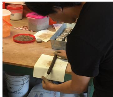
**Figura 3:** Ensayo de cohesividad realizado a barras de tierra en estado plástico.
