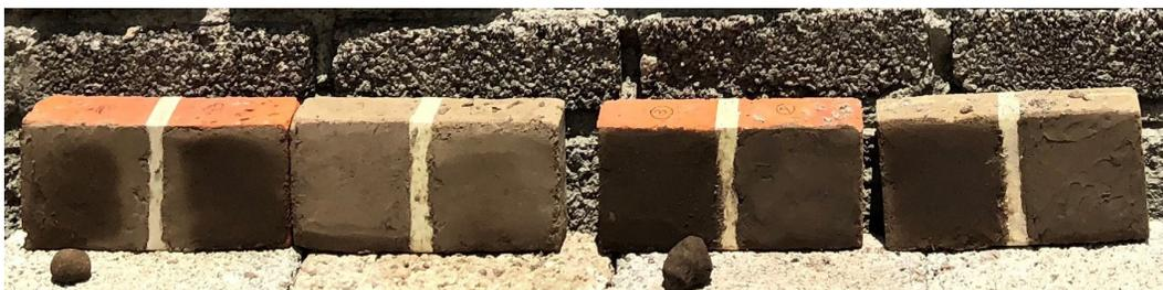
**Figura 6:** Evaluación de los revestimientos aplicados sobre diferentes tipos de bloques y dejados a la intemperie
