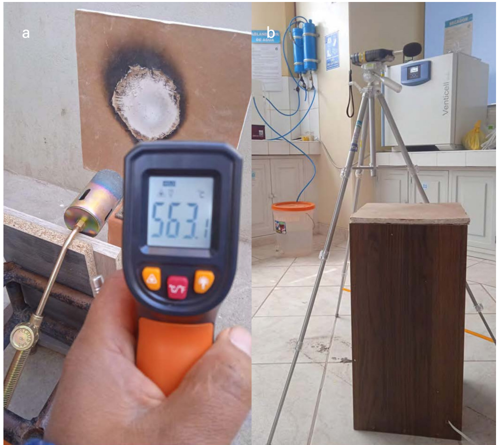
Figura 3: (a) Ensayo de resistencia al fuego. (b) Ensayo de aislamiento acústico. (2024)
