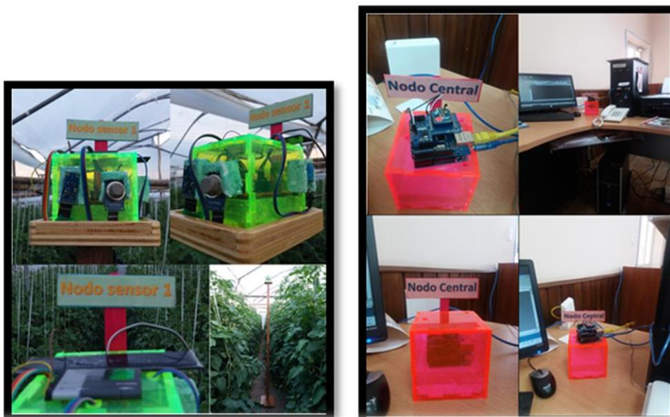
**Figura 8.** Instalación Nodo sensor 1, ubicado en la plantación de tomate en la ubicación correcta y la instalación del nodo central ubicado en la residencia de los estudiantes.
