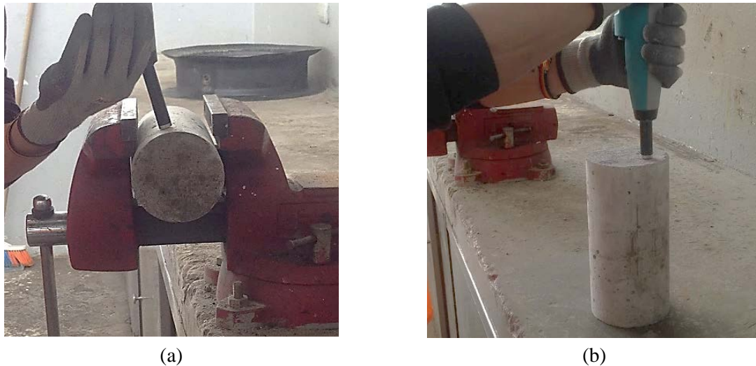
Figura 1. Condiciones de apoyo de las probetas (a) fija (b) libre.
