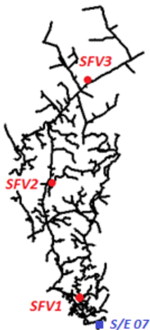
Figura 3. Alimentador de distribución 0723 importado a DlgSILENT a partir del GIS.
