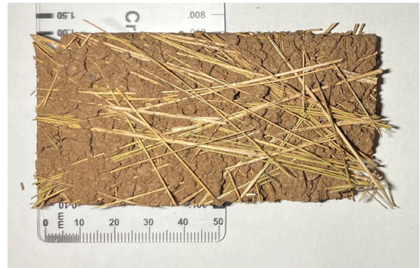
Figura 7: Comparativa de agrietamiento en la cara inferior Fuente: Elaboración propia
