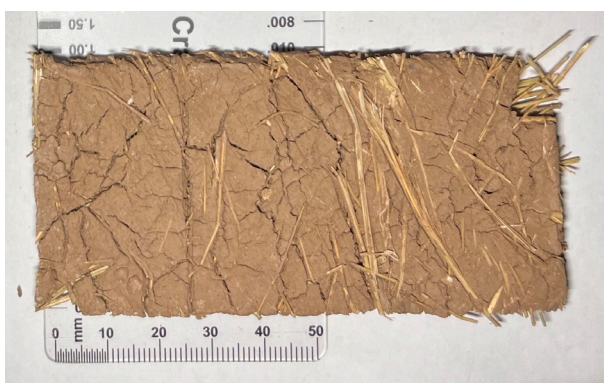
Figura 8: Comparativa de agrietamiento en la cara superior. Fuente: Elaboración propia
