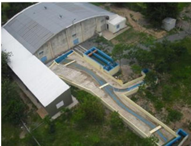
**Figura 1.** Modelo Físico Suquía-Cañada (Fuente: Laboratorio de Hidráulica de la Universidad Nacional de Córdoba).
