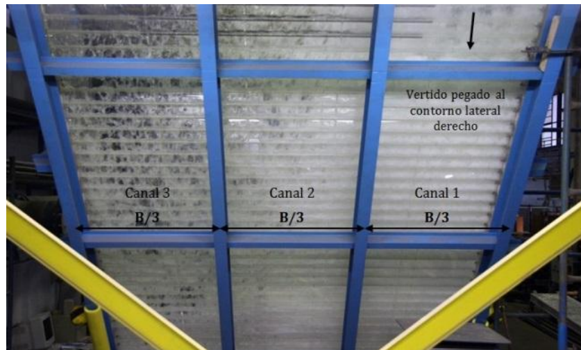
Figura 1. Vista posterior de la expansión lateral respecto al llenado de los escalones. Ensayo b_0/B=1/3 y (y_c/h)_e=1.14 .
