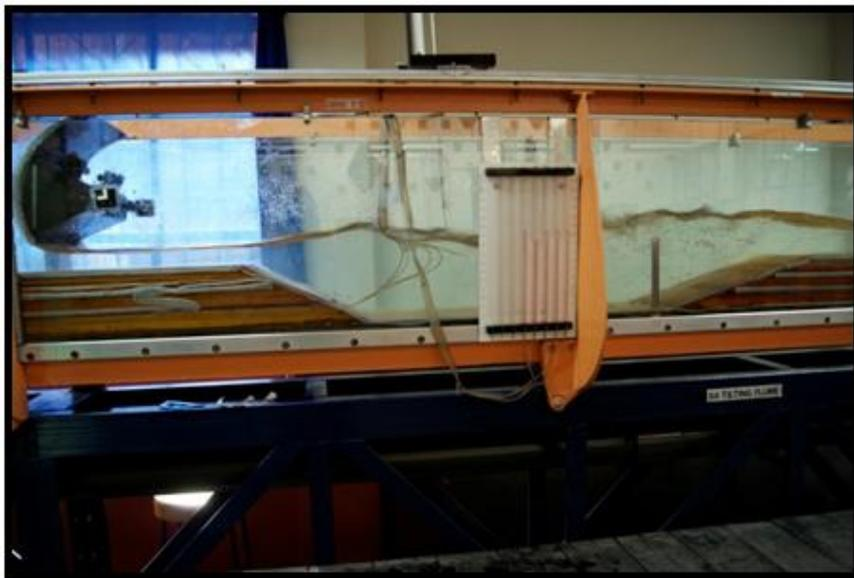
**Figura 1.** Ilustración de un ensayo:  $P = 3$ ,  $z = 2$  y  $Q = 20.12$  l/s, equivalente a  $600$  m<sup>3</sup>/s.  $H = 20.6$  cm. La apertura de la compuerta,  $a$ , es 5.8 cm. La presión es medida en el talud de ingreso al cuenco disipador mediante los tubos piezométricos.
