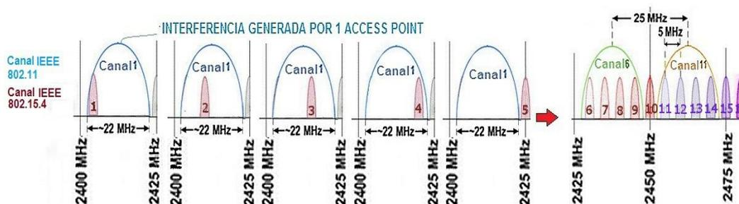
**Figura 6.** Interferencia de canales IEEE802.15.4 e IEEE802.11 en experimento 2.
