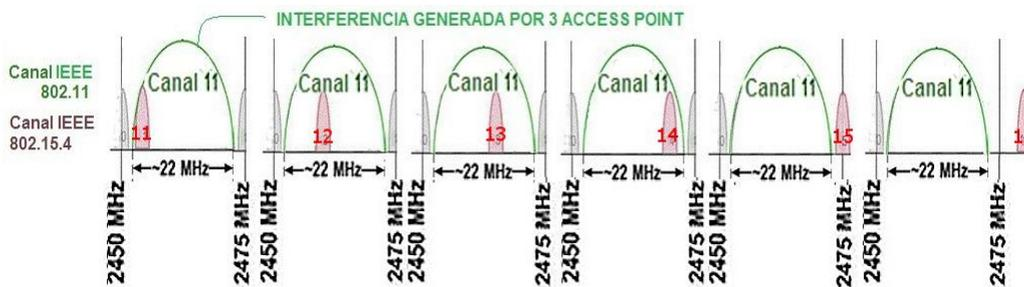
Figura 8. Interferencia de canales IEEE802.15.4 y canal 11 IEEE802.11 en experimento 4.
