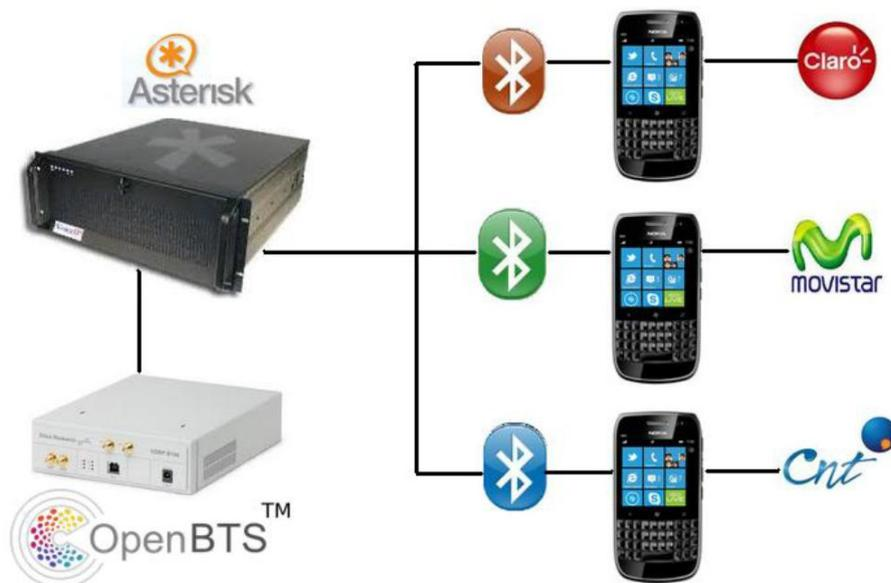
**Figura 4.** Esquema de conexión Chan\_Mobile.
