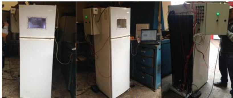
Figura 15. Refrigerador instrumentado. Fuente: Autores
