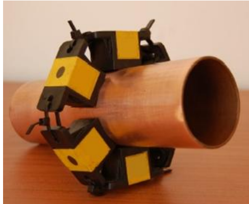
Figura 3. Sistema de Imanes Permanentes acoplados a una tubería.
