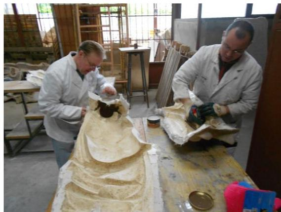
Tratamiento del molde semi-flexible para positivar en resina de poliéster.
