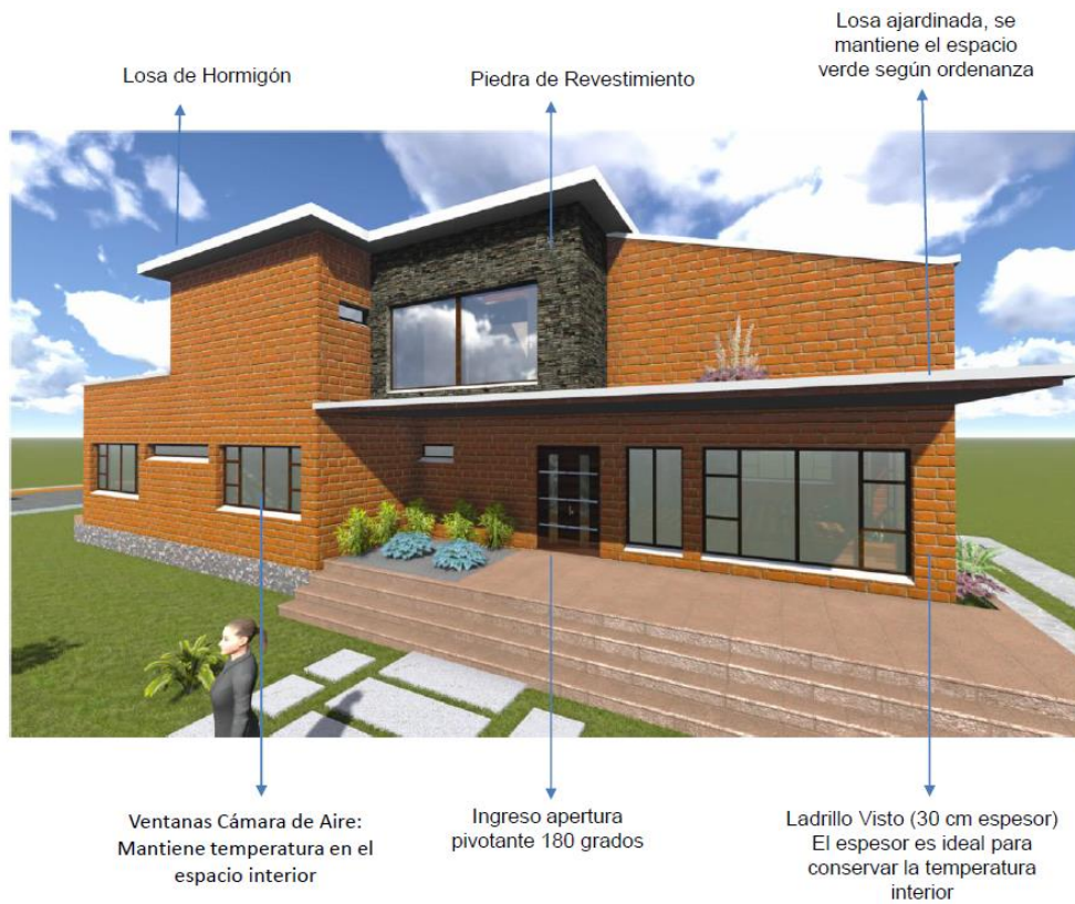
Fig. 16. Estructura hormigón. Elaboración propia
