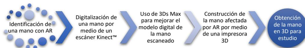
Figura 2. Esquema del proceso de prototipado de una mano mediante técnicas DIGITALIZACION-DAO-RP
