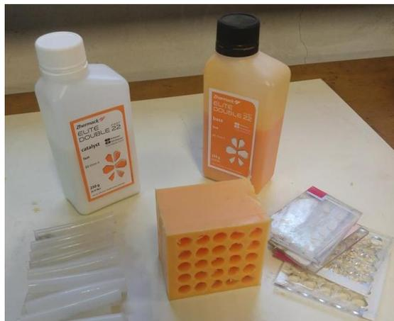
Figura 2. Metamaterial fabricado a base de una doble composición elastomérica de silicona Zhermack elite Double 22, utilizando el método propuesto por Bintein et al. (2018).
